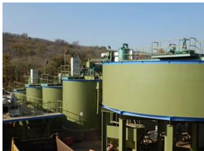
Fig. 3 Proceso convencional de carbón en pulpa, lixiviado con solución de cianuro de sodio.
